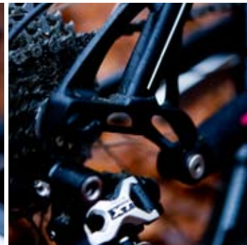
Horst linket og den asymmetriske bagende er opskriften på kraftoverførsel og sensitivitet.
