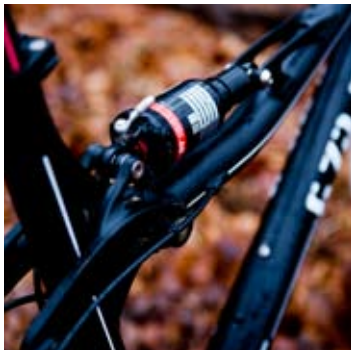
APLS systemet giver rammen sin helt egen identitet. DT Swiss dæmperen leverer 100 mm vanding.
